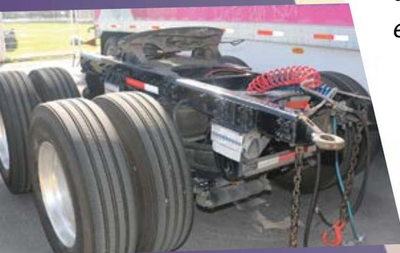
El dolly tipo “H” se integra por un chasis de acero de alta resistencia diseñado para brindar la flexibilidad y firmeza necesarias para absorber cargas y esfuerzos generados en la conducción sobre terrenos irregulares y frenados bruscos.
