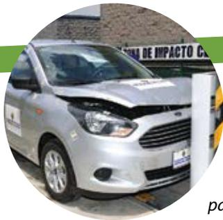
*Dentro del análisis de reparabilidad que se realiza en Cesvi México, el **Ford Figo 2016** fue impactado por la parte delantera izquierda y trasera derecha a una velocidad de entre 15 y 16 Km/h, con un desfase de 10° con respecto al frente del vehículo.*
