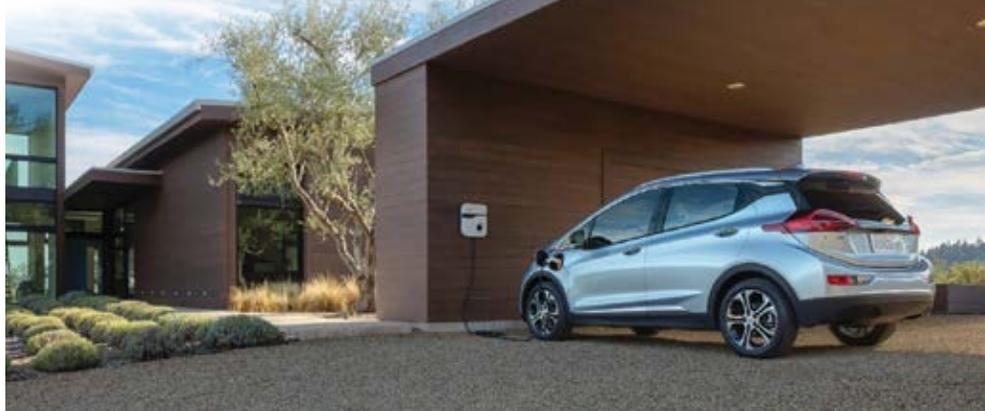
Chevrolet Bolt EV ofrece un rango de manejo promedio de 383 km con una carga completa. Su motor eléctrico es capaz de generar 200 caballos de fuerza y 265 lb-pie de torque, impulsado por una batería de ion-litio de (60 kWh) de última generación. La suspensión es semi-independiente McPherson performance en la parte delantera y con barra de torsión trasera.
