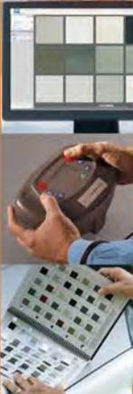
Desde la más completa guía cromática impresa de *catálogos de color*, *cajas de color* y *decks de variantes* aplicados con pintura original con referencias OEM, hasta la más innovadora tecnología con nuestro avanzado *espectrofotómetro RapidMatch® X-5*, el cual da lectura de color en 5 ángulos diferentes para obtener la formulación más acertada.
