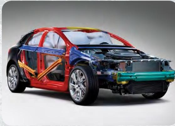
**Facilidad de reparación.** Una carrocería debe tener fácil acceso a los métodos de unión como remaches, soldadura y tornillos para una fácil reparación en caso de ser necesaria.
