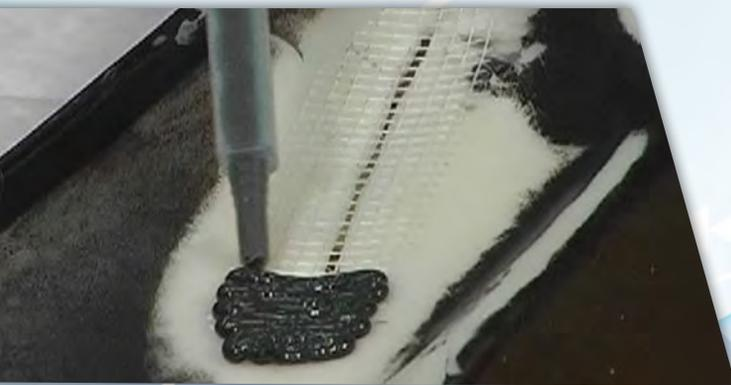
La temperatura es un factor importante para llevar el material a un estado pastoso y para que se efectúe una perfecta unión molecular. Cada material llega a fluir a una determinada temperatura, la cual es distinta de un material a otro.
