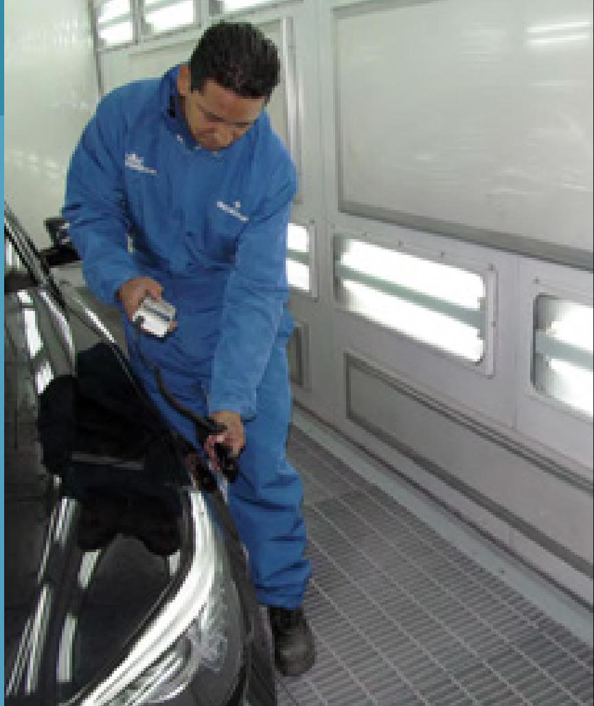
Mediante el adecuado uso y aplicación de pinturas de acabado en la cabina se obtienen resultados que no son comparables con la aplicación fuera de ésta. Debemos considerar que al tener sistemas de pintura que requieren de la evaporación de un disolvente la temperatura y flujo de aire controlado benefician sustancialmente la operación.
