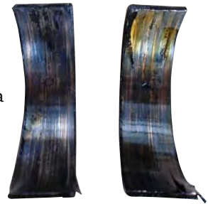
Daños en cojinetes de biela
