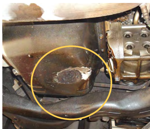
Daño en la parte inferior del cárter de aceite del motor
