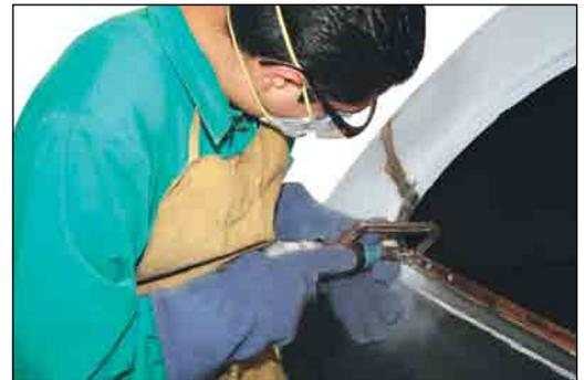
**6. Realizar el corte:** una vez retirados los puntos por resistencia y delimitada la zona en donde ha de efectuarse el corte, se verifica que el equipo esté en las óptimas condiciones para la operación:
