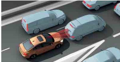
**b)** Si el sistema detecta una acción inminente de colisión, ya sea contra un cuerpo duro o semoviente se activa en primera instancia una señal auditiva, la cual deberá alertar al conductor para iniciar las acciones de frenado pertinentes.
