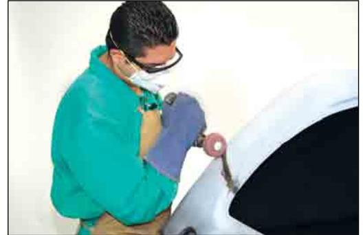
**5. Delimitar el área a cortar:** con una despunteadora y broca de 8 mm de diámetro se retiran los puntos de resistencia previamente descubiertos.
