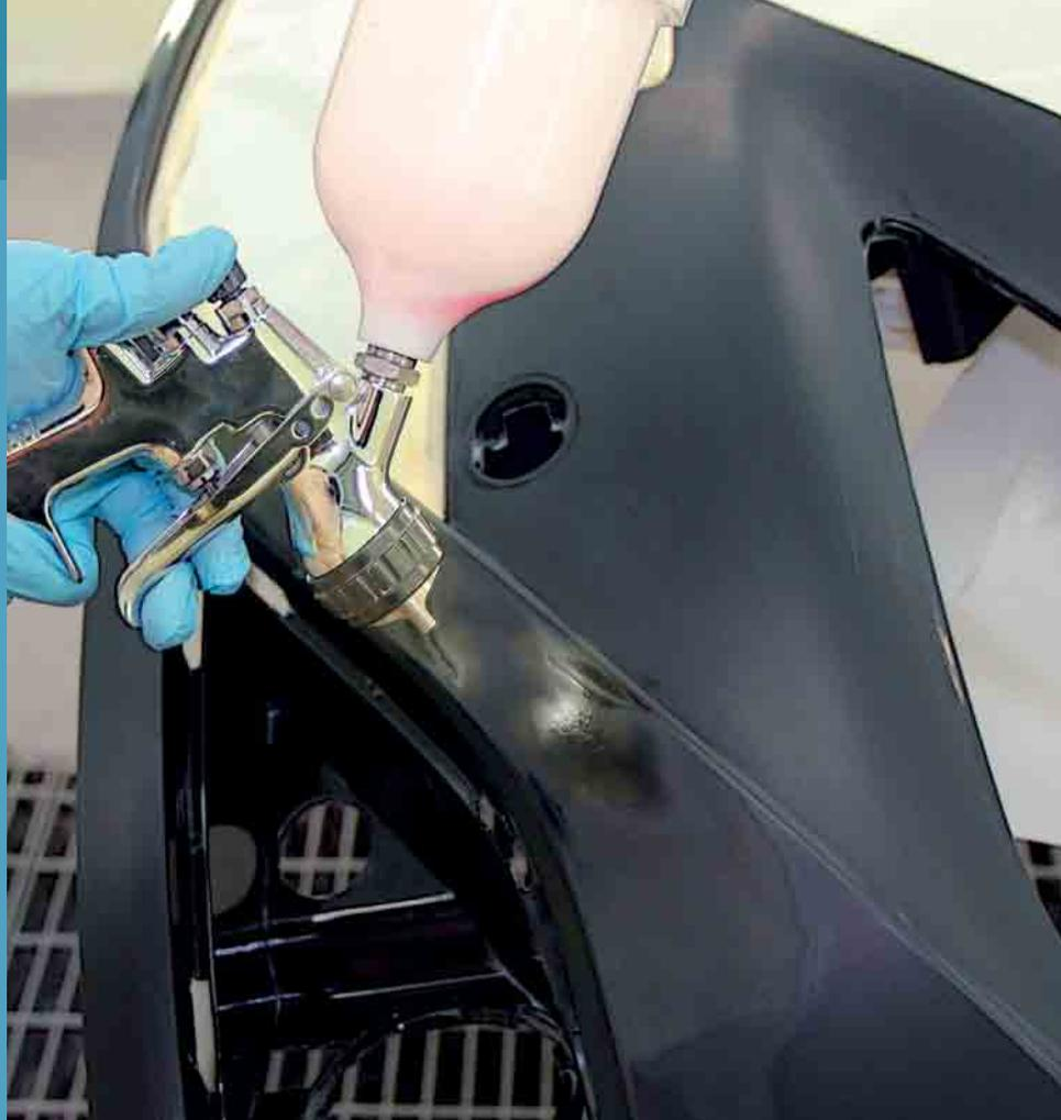
Esta pintura de cataforesis también se aplica en las piezas de recambio, con el fin de protegerlas de la oxidación durante su almacenaje y transporte. En el repintado, las imprimaciones anticorrosivas se encargan de proporcionar esa protección frente a la oxidación, además de servir como promotor de adherencia para las posteriores capas de pintura.
