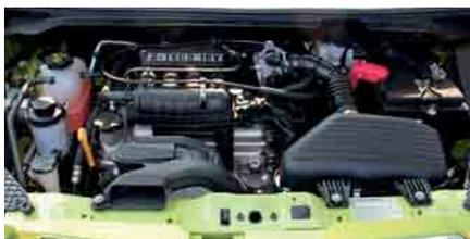
El motor del Chevrolet Spark 2011 está colocado en posición transversal, es de cuatro cilindros y 16 válvulas, cuenta con inyección directa de combustible además de dirección hidráulica.
