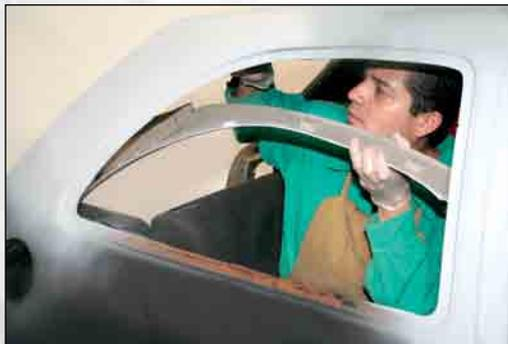
**3. Proteger la parte interna con manta ignífuga:** ya desmontados los accesorios, se cubre la zona para evitar chispas incandescentes con dicha manta (cielo, alfombra de piso, asientos, respaldo de asientos, etc.).
