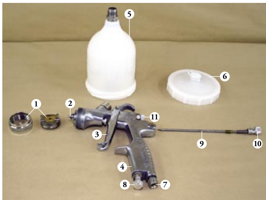
Principales componentes de la Pistola SGK-600-BV de Devilbiss
