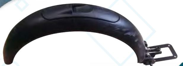
**Unión de la pieza:** 4 tornillos 3 mm allen y 1 conector
