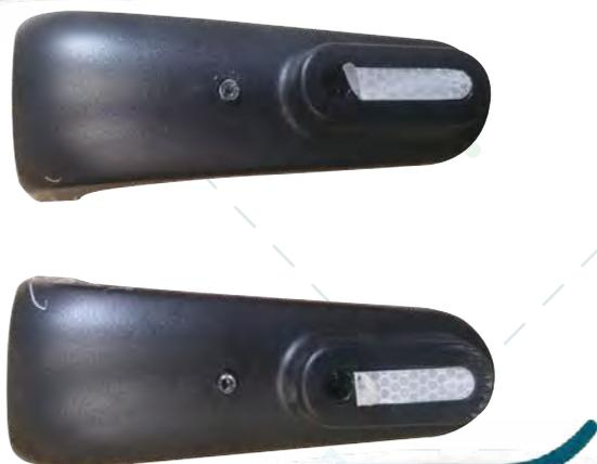
**Unión de la pieza:** 2 tornillos 3 mm allen por lado
