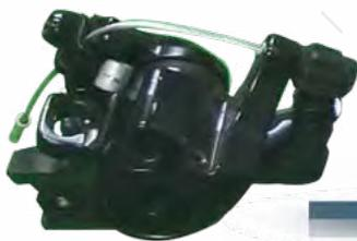
**Unión de la pieza:** 2 tornillos 5 mm allen
