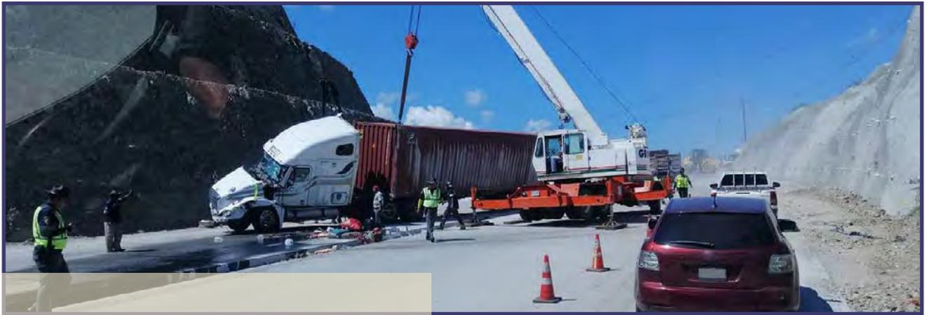
*Los semirremolques de tipo caja seca al tener un centro de gravedad alto y ofrecer una mayor superficie de resistencia ante los vientos cruzados, suelen ser las configuraciones que con mayor frecuencia se voltean. También sufren de volcaduras los semirremolques cuya carga está mal estibada, distribuida o si transporta líquidos, el tanque no cuenta con rompeolas.*
